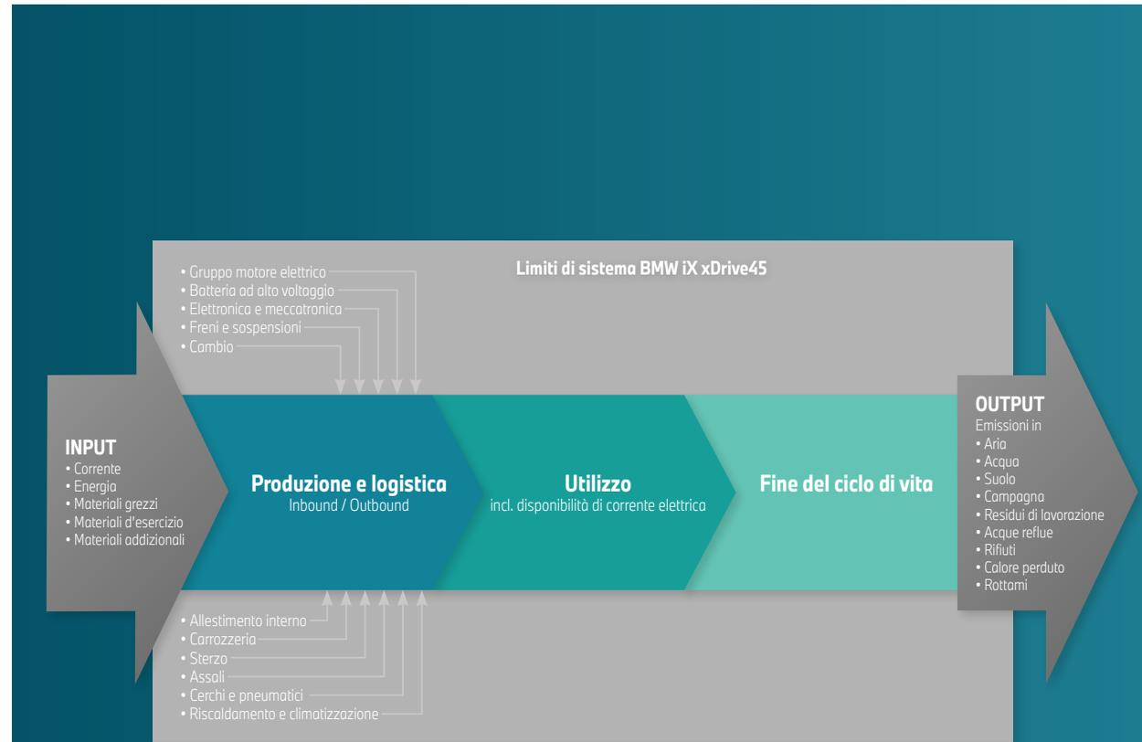
Fig. 1: Limiti di sistema ecobilancio BMW iX xDrive45
