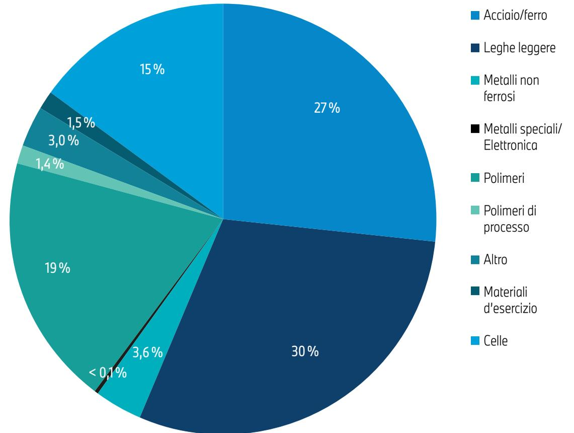
Fig. 2: Composizione dei materiali della BMW iX xDrive45 all'inizio della produzione. I valori indicati possono presentare differenze di arrotondamento.
