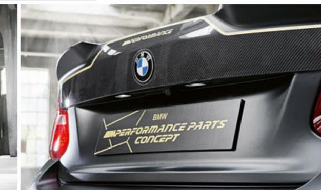
Viele werden es nur von hinten sehen: 5 kg Gewicht spart die Heckklappe aus Carbon.
