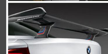
Der durchströmte Heckspoiler erhöht den Anpressdruck und trägt damit zu einer besseren Straßenlage bei.
