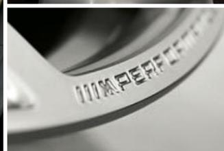
Du forgeage de la pièce brute à l'application de plusieurs couches de vernis mat, en passant par le fluotournage de la base de jante, le fraisage et le polissage, la jante forgée 763 M nécessite environ 22 heures de travail.
