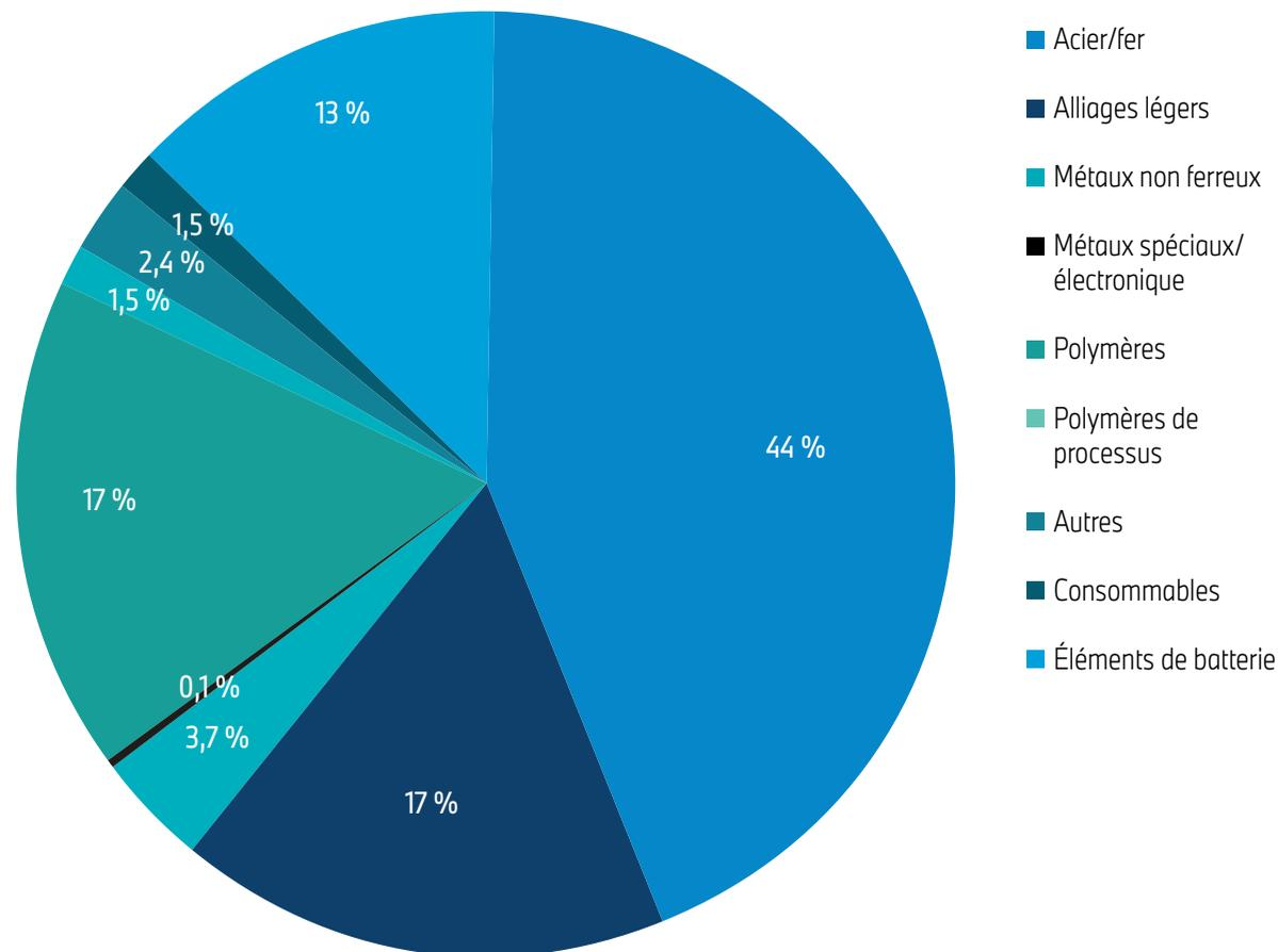
Fig. 2 : Composition des matériaux de la BMW iX2 xDrive30 au lancement de la production
